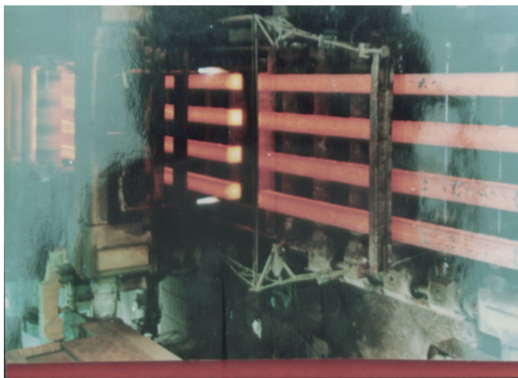
1965 年为重钢公司设计的 2300 弧形连铸机在浇钢
